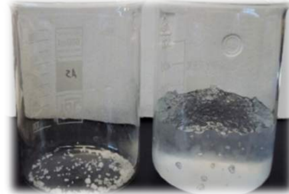
Idroritettori: aumento in volume fino a 200 volte
