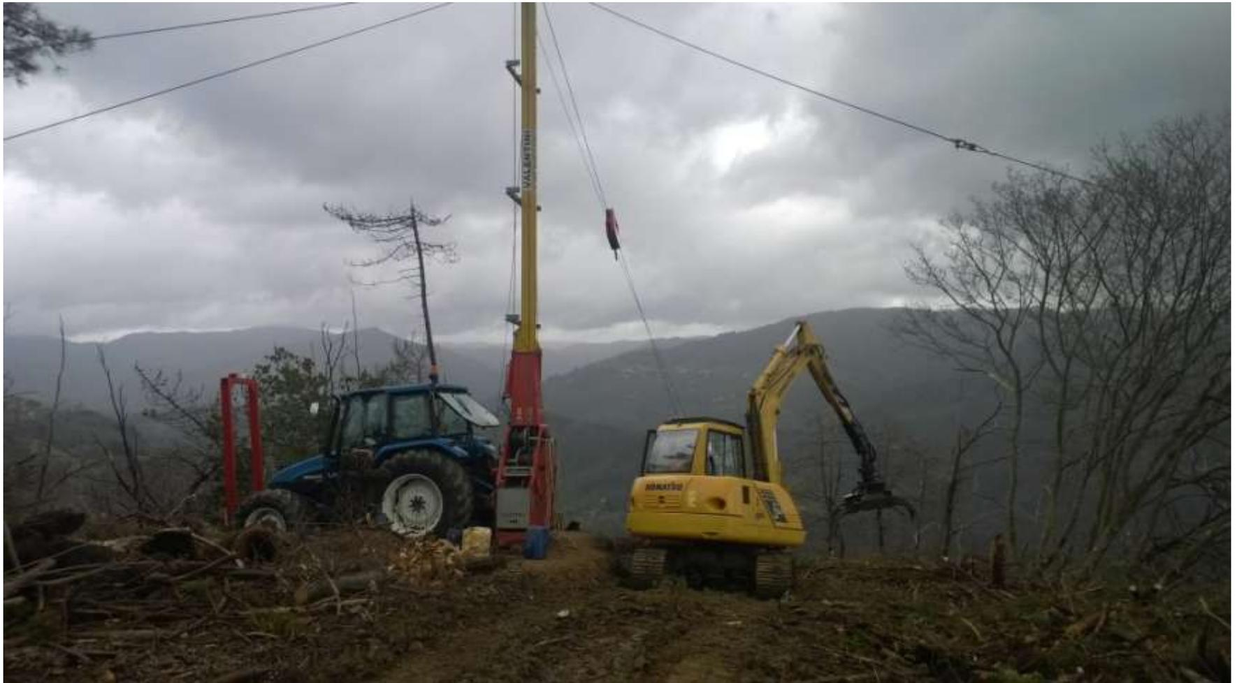
Abbattimento con motosega; esbosco con teleferica montata su trattore; movimentazione del materiale con escavatore dotato di pinza e rotore
