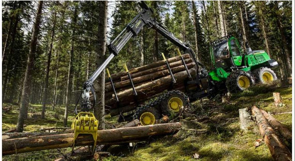
Il principio di funzionamento di tali macchinari è basato sul taglio ed il prelievo direttamente dal sito di abbattimento delle piante forestali, maneggiando la pianta intera attraverso un braccio meccanico anziché – come nella selvicoltura tradizionale – abbattendo la pianta e trascinandola con un verricello fino alla viabilità forestale.
